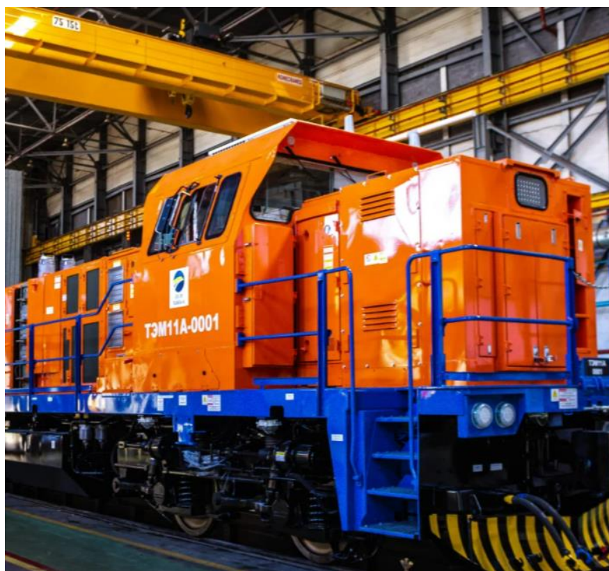
Сурет 1.1- ТЭМ11А сериялы маневрлік тепловозы
